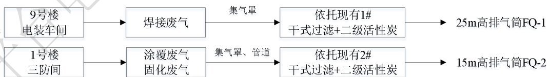
图 4.2-1 本项目废气处理流程图
