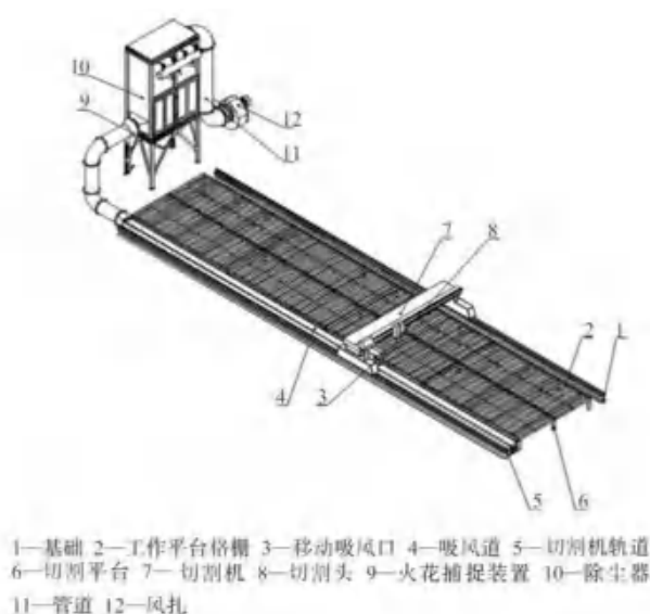
切割机烟尘治理系统示意图
