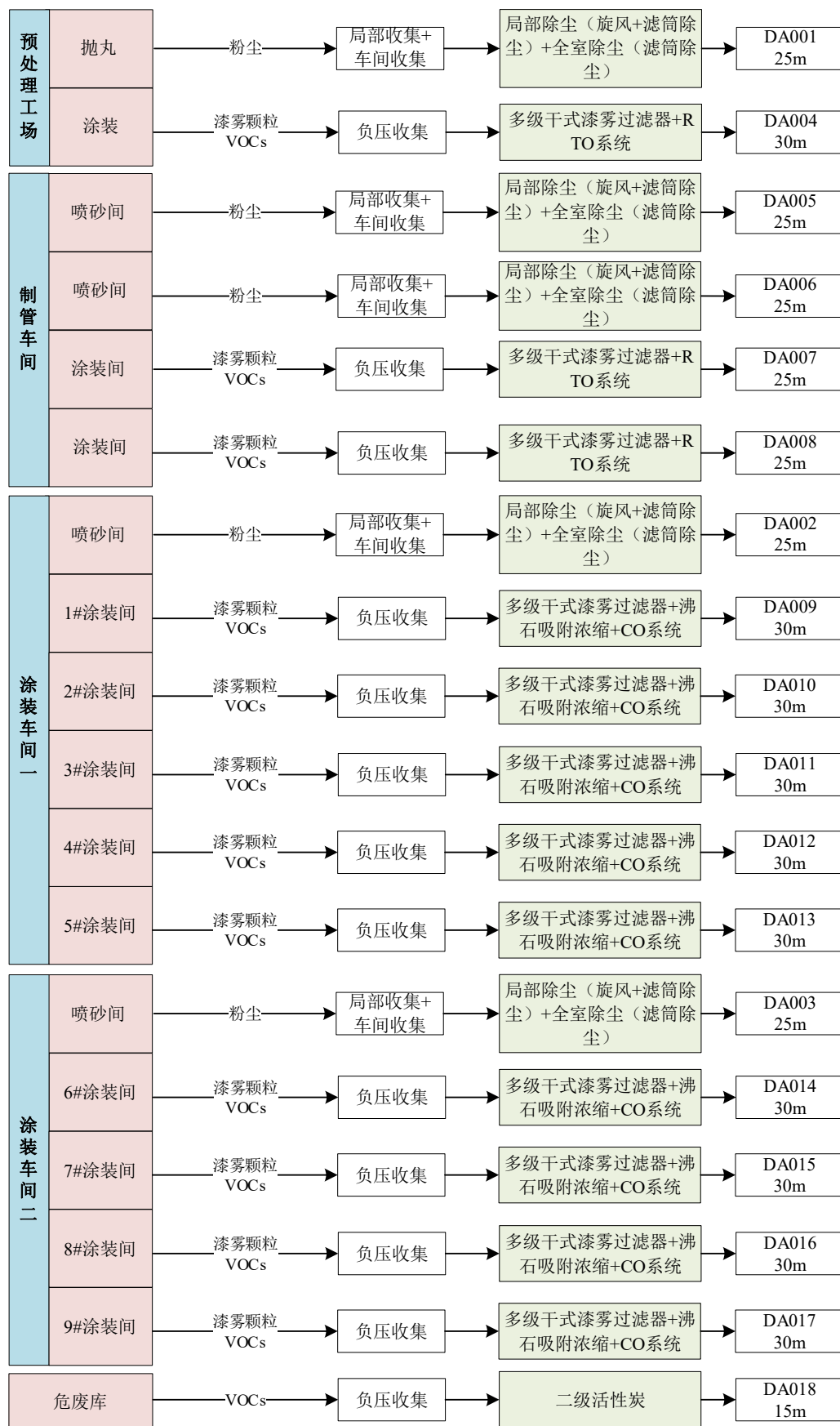
图 6.1-1 本项目废气收集和治理措施流程图（有组织）
