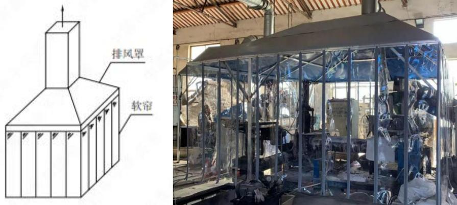
图 4-1 集气罩（含软帘）示意图及案例图
