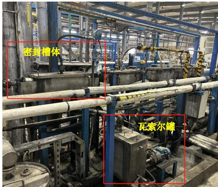
(3) 清洗 2、纯水洗：清洗 1 结束后，为去除工件表面的瓦索尔，此处采用氢氧化钾溶液和纯水进行二次清洗。工件先经历 1 道碱洗、2 道纯水洗，再经历 1 道碱洗、3 道纯水洗。上述碱洗、纯水洗所用介质均由 1 个碱罐、3 个纯水罐（1#纯水罐、2#纯水罐、3#纯水罐）供给。此清洗过程均采用喷淋方式，碱洗温度在 25-85℃之间。热水锅炉提供热水加热，时间控制在 30min 内。设置的 1 个碱罐、3 个纯水罐，均为 8m<sup>3</sup>。
