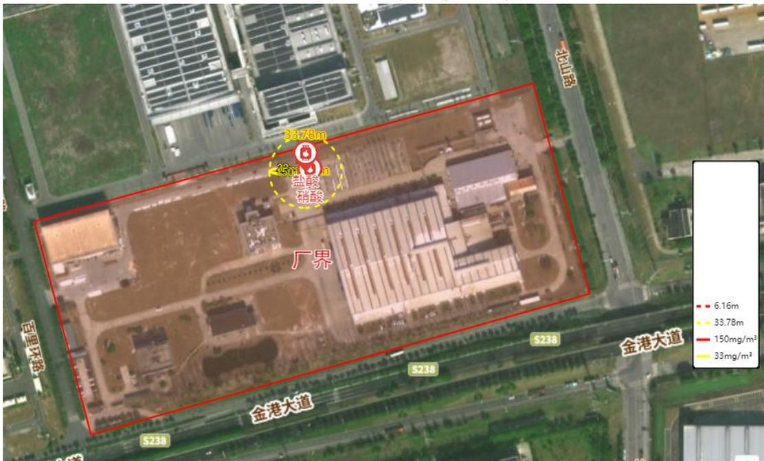
图 9-3 发生地最不利气象条件下泄漏氯化氢最大影响区域图
