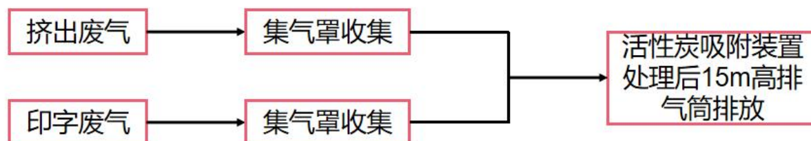
图 3-2 废气处理工艺流程图
